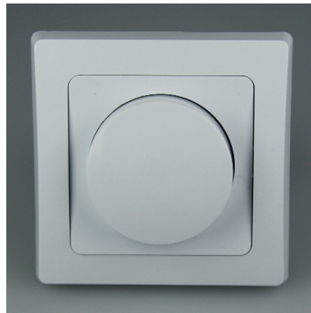
Art.-Nr. 19721: Dimmer für elektr. Trafos • 230V / 300W • inkl. Rahmen • Sicherung 250V~/2A
