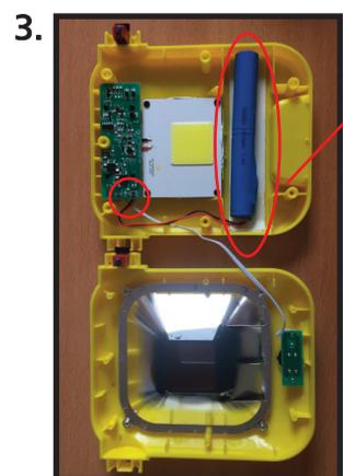
3. Entfernen Sie nun den Stecker des Akkus von der Platine der Ladeelektronik. Der Akku ist leicht im Gehäuse verklebt, ziehen Sie ihn vorsichtig ab, und verkleben Sie danach den Stecker der Leitung am Akku mit Isolierband.
